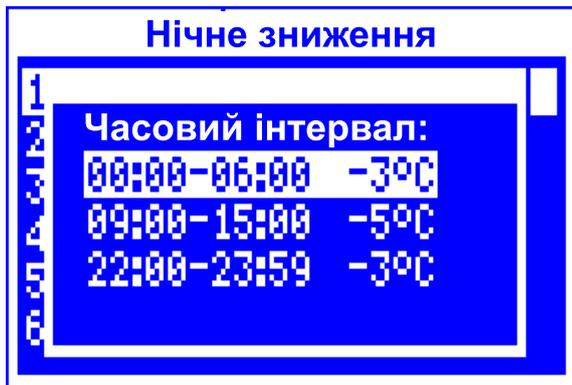
У представленому прикладі з 00:00 до 06:00 регулятор встановить зниження заданої температури котла на 3 °С. З 06:00 до 09:00 регулятор залишить задану температуру котла на заданому рівні (без знижень). З 09:00 до 15:00 регулятор знизить задану температуру котла на 5 °С. З 15:00 до 22:00 регулятор знову залишить задану температуру котла на заданому рівні (без знижень). З 22:00 до 23:59 регулятор знизить задану температуру котла на 3 °С.
