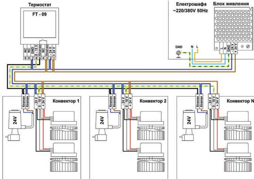
**СХЕМА ПІДКЛЮЧЕННЯ ДЕКІЛЬКОХ КОНВЕКТОРІВ
