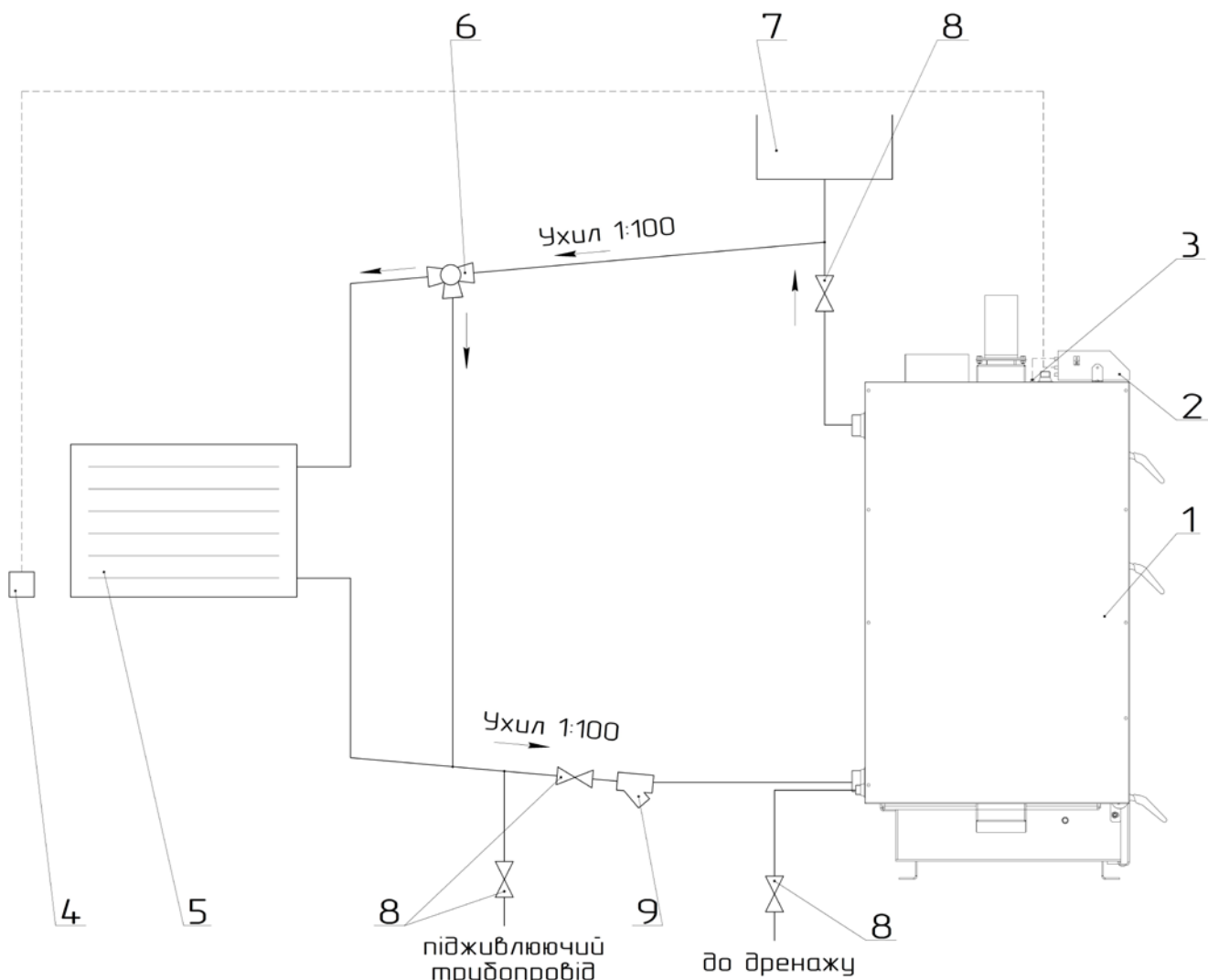
Рисунок 4 – Схема підключення котла до системи опалення з природною циркуляцією теплоносія
